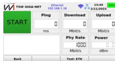
O TSW GIGA-NET é um equipamento para análise e teste da conexão com a internet, que permite validar a largura de banda, as taxas de transferências e a qualidade de sinal, tanto em portas Gigabit Ethernet quanto via Wi-Fi (INCLUINDO WI-FI 6).
